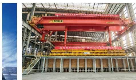
Первый в мире полностью автоматический кран для линии намотки и сборки углеграфита
