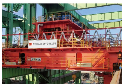
Самый грузоподъёмный в Китае металлургический разливочный кран — 500 т
