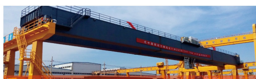
Крупнейший в мире мостовой кран для помещений — пролёт 70 м, для АЭС
