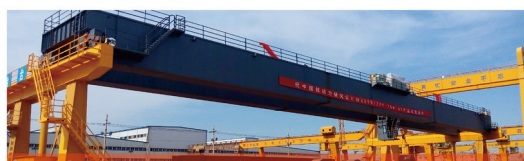
Крупнейший в мире мостовой кран для помещений — пролёт 70 м, для АЭС
